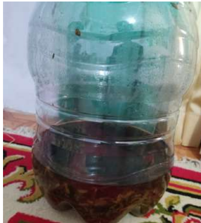
Gambar 5 : Proses ekstraksi daun sirih dengan pelarut ethanol 70%
