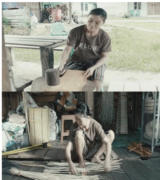
Gambar 4. Scene pengolahan batang rotan basah menjadi lembaran rotan bahan anyaman
